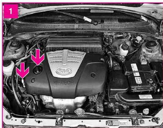
Места расположения масляного щупа и маслозаливной горловины указаны стрелками
