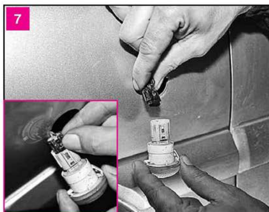
Нажимаем на фиксатор колодки проводов и отсоединяем ее от разъема патрона лампы. Новый плафон устанавливаем в обратной последовательности
