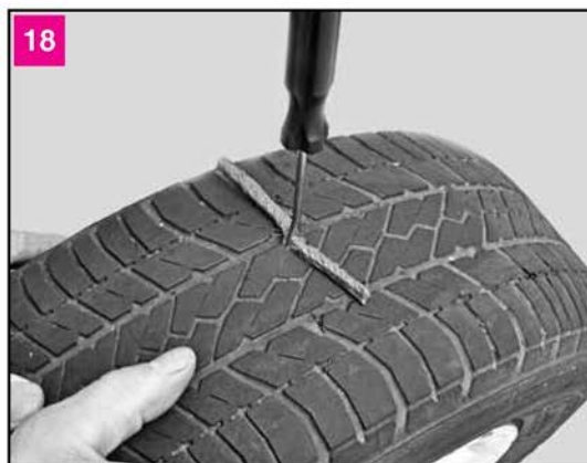
18 Вынимаем из отверстия в шине шило с насечками и вместо него быстро вставляем в прокол конец шила с прорезью вместе с самовулканизирующимся жгутом
