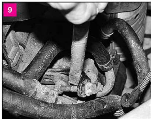
Монтажной лопаткой сдвигаем насос гидроусилителя руля вперед (в направлении от двигателя)
