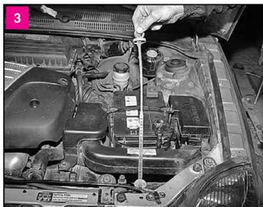
Вынимаем крышку-щуп из расширительного бачка. Протираем его тканью, опускаем в горловину расширительного бачка и аккуратно извлекаем. Охлаждающая жидкость заполняет прорези в стержне щупа
