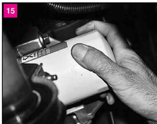
15 Заворачиваем фильтр на место от руки
