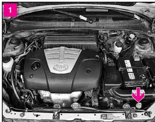
Расширительный бачок установлен в моторном отсеке слева (глядя по ходу движения автомобиля)
