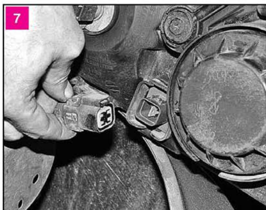
Отсоединяем колодку проводов от разъема блок-фары
