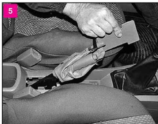
5 Сдвигаем чехол по рукоятке рычага стояночного тормоза
