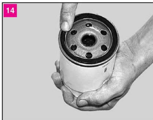
14 Наносим свежее моторное масло на уплотнительное кольцо фильтра
