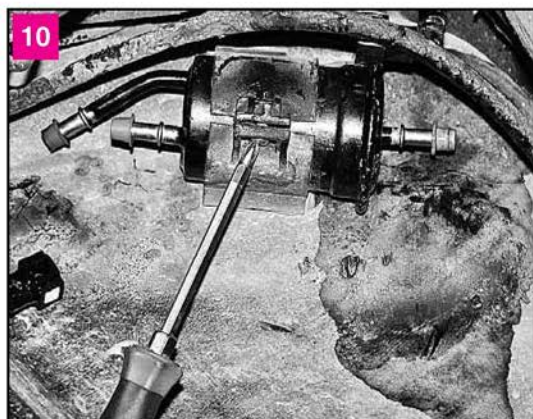
Крестообразной отверткой отворачиваем стяжной винт кронштейна крепления фильтра
