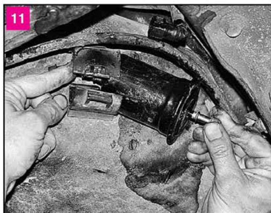
Вынимаем фильтр из кронштейна. Сливаем остатки топлива из фильтра в емкость. Новый топливный фильтр устанавливаем в обратной последовательности. Наконечники топливных трубок надеваем на штуцеры фильтра до защелкивания фиксаторов
