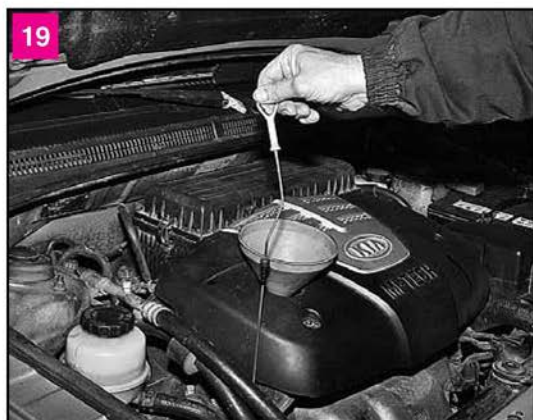
Вставляем щуп в направляющую трубку до упора и вынимаем его. По кромке масляной пленки на щупе определяем уровень масла в поддоне картера двигателя, она должна находиться между метками, отмеченными буквами L и F (см. фото 20)
