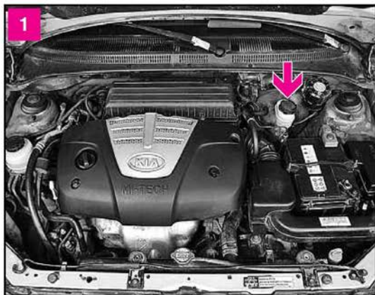
Место расположения бачка с тормозной жидкостью показано стрелкой
