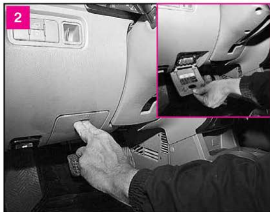
Для доступа к блоку тянем крышку вниз и снимаем ее
