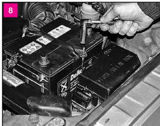
Высокой головкой «на 10» ослабляем две гайки крепления прижимной планки аккумулятора
