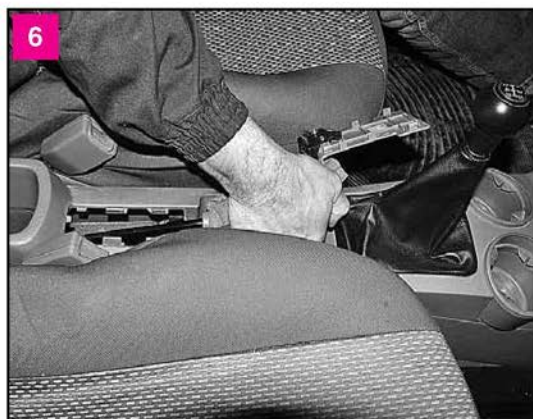
6 Опускаем рычаг стояночного тормоза до упора
