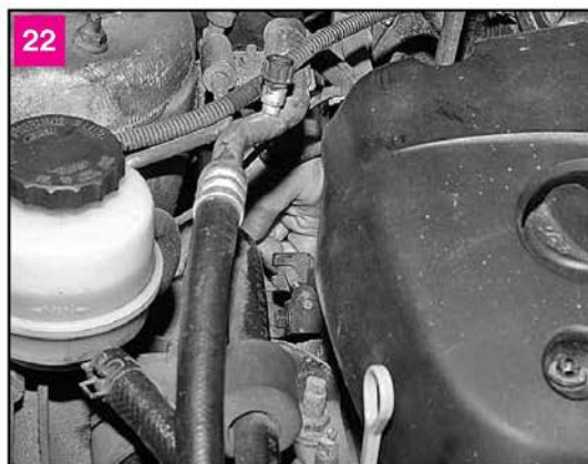
Сдвигаем генератор в сторону двигателя
