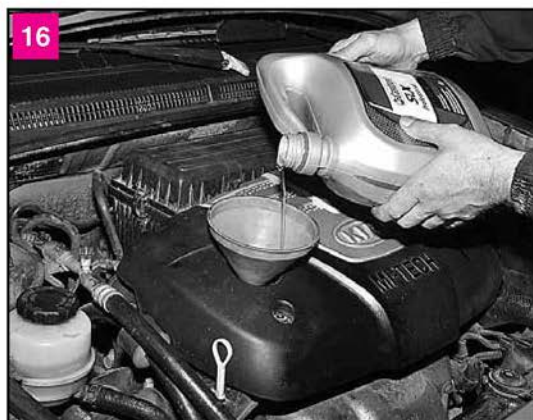
16 Через маслозаливную горловину заливаем в двигатель 3,0 л масла
