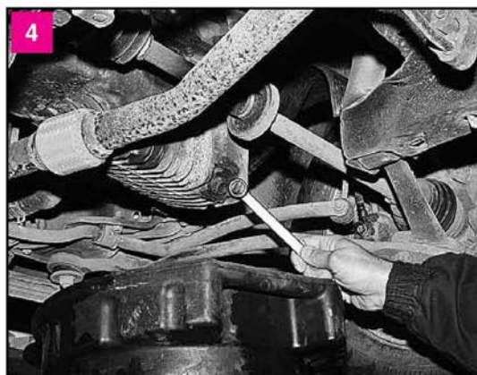
Ослабляем затяжку пробки накидным ключом или головкой «на 17»
