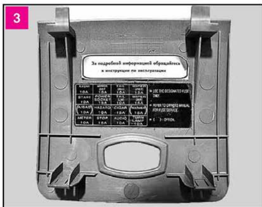
На внутренней стороне крышки нанесена схема расположения предохранителей и дана информация об их назначении
