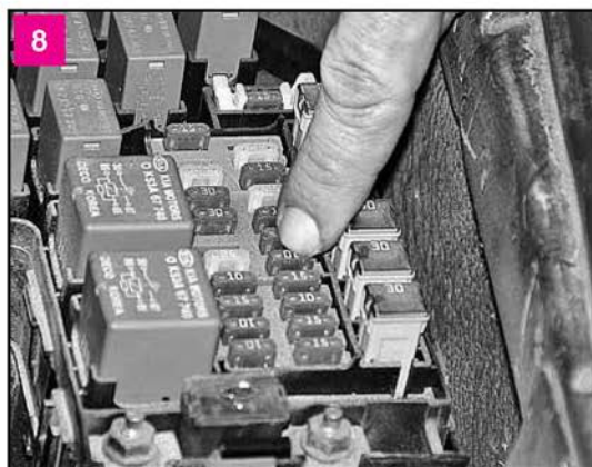
Новый предохранитель вставляем в гнездо блока до упора
