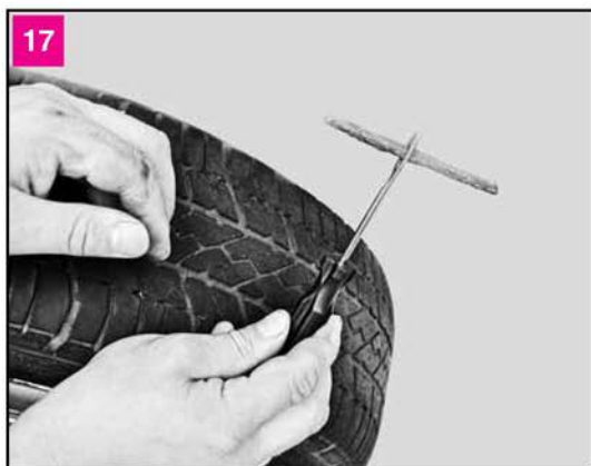
17 Прodeваем самовулканизирующийся жгут в прорезь второго шила
