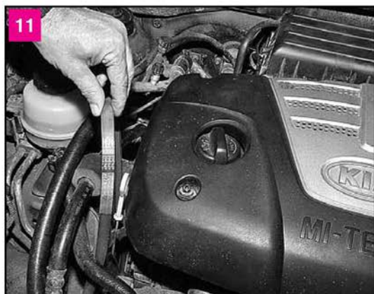
Снимаем ремень со шкивов коленчатого вала и компрессора кондиционера. Устанавливаем ремень привода насоса гидроусилителя руля и компрессора кондиционера в обратной последовательности
