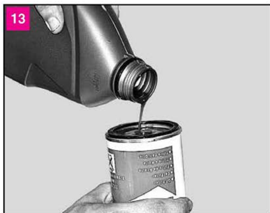
13 Заполняем новый масляный фильтр свежим моторным маслом
