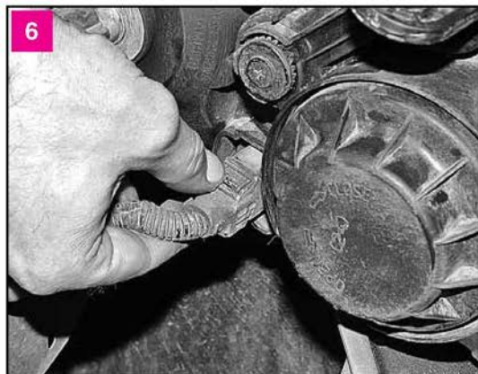
Нажимаем на фиксатор колодки проводов
