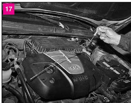
Через 3–4 мин (масло должно успеть стечь в поддон) вынимаем щуп из направляющей трубки
