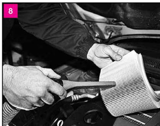
Осматриваем сменный элемент воздушного фильтра. При необходимости его можно пропылесосить. Порванный, сильно загрязненный (закопченный) или отслуживший свой срок элемент меняем. Устанавливаем элемент в обратной последовательности
