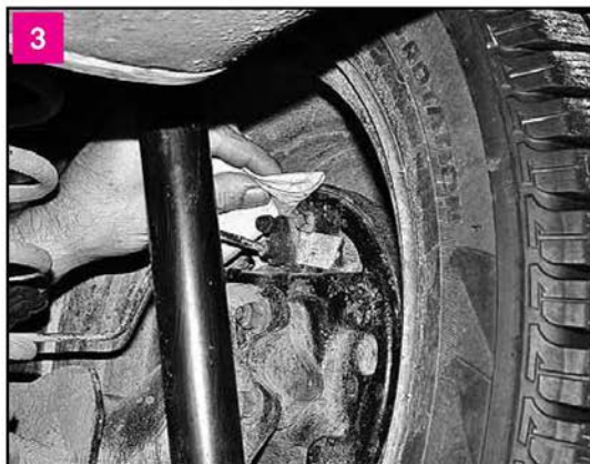
Очищаем от грязи место вокруг штуцера прокачки тормозного механизма правого заднего колеса
