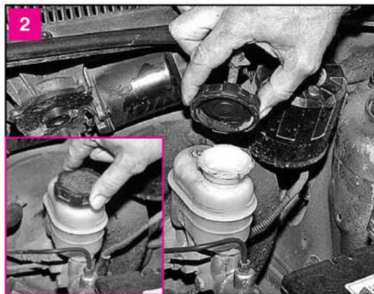
Поворачиваем против часовой стрелки крышку бачка и снимаем ее
