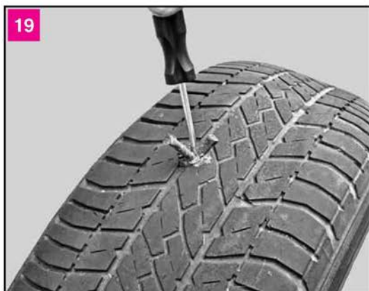
19 Вводим шило со жгутом в прокол так, чтобы снаружи остались концы жгута длиной по 10–15 мм. Если жгут оборвался или провалился внутрь шины, повторяем операцию с другим жгутом (в набор для ремонта шины входят 4–5 жгутов)
