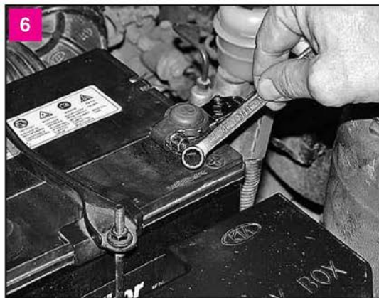
Ключом или головкой «на 10» ослабляем гайку стяжного болта клеммы провода на «плюсовом» выводе аккумулятора
