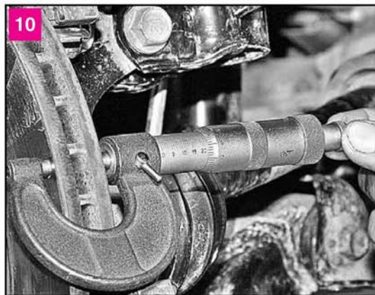
10 Перед установкой колодок микрометром или штангенциркулем замеряем толщину тормозного диска. Если толщина его меньше 19 мм, диск необходимо заменить
