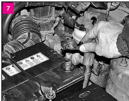
Поворачивая, снимаем клемму провода с «плюсового» вывода аккумулятора и отводим провод с клеммой в сторону
