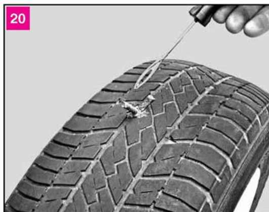
20 Рывком выдергиваем шило из шины. Благодаря разрезному концу шила жгут остается в отверстии. Обрезаем выступающие концы жгута на высоте 3 мм над протектором шины
