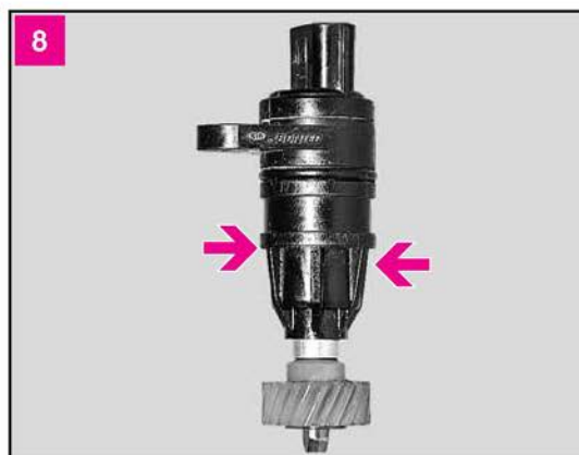
По кромке масляной пленки на датчике определяем уровень масла в коробке передач. Она должна находиться на уровне, указанном стрелками
