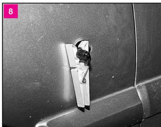
Провода, подходящие к колодке, имеют небольшую длину, поэтому, для того чтобы колодка не упала внутрь колесной ниши, ее следует закрепить любым удобным способом
