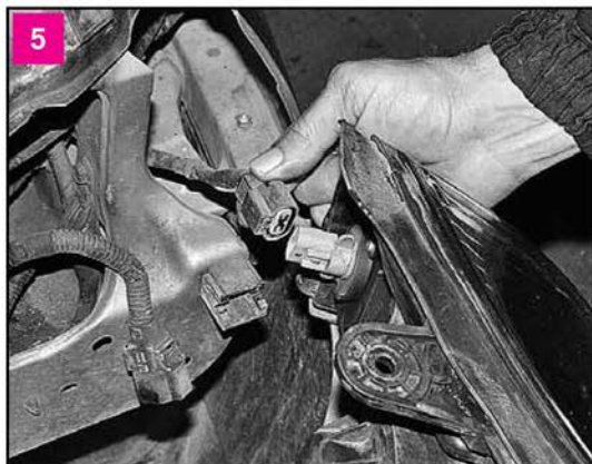
Отсоединяем колодку проводов от разъема патрона лампы указателя поворота
